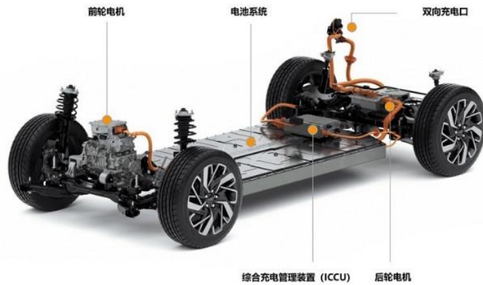
图表3-1 E-GMP 电动汽车模块化平台
